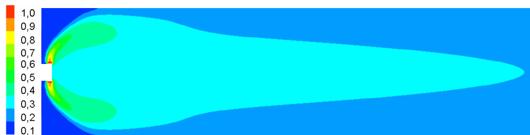
Figura 4.1.2: Distribuição da concentração mássica de combustível para o bico injetor de fluxo radial com o modelo de turbulência “k- \epsilon ”
