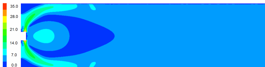
Figura 4.2.6: Distribuição de velocidades para o bico injetor de fluxo radial sem o modelo de combustão (m/s)
